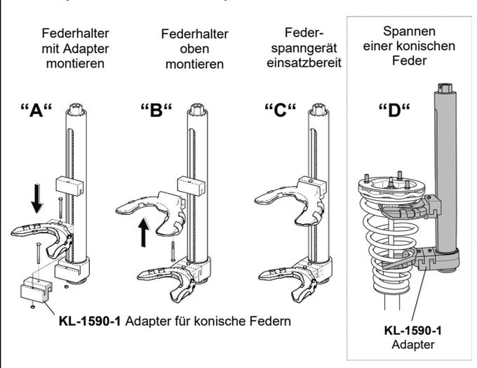
Federspanngerät mit dem richtigen Federhalterpaar komplettieren.
