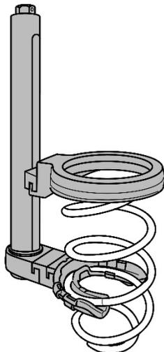
**(Methode 2): Feder einbauen, mit Spezial-Federhaltern, die auf den oberen Federteller greifen.**
