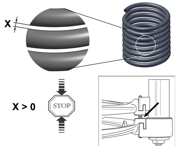
Zum Spannen der Feder die Antriebsmutter, wie in **Abb. 17** gezeigt, mit einer 1/2"-Umschaltknarre in Verbindung mit einem Steckschlüsseinsatz SW 24 mm, im Uhrzeigersinn drehen und Feder soweit spannen, bis keine Spannung mehr auf der Kolenstangenmutter ist.
