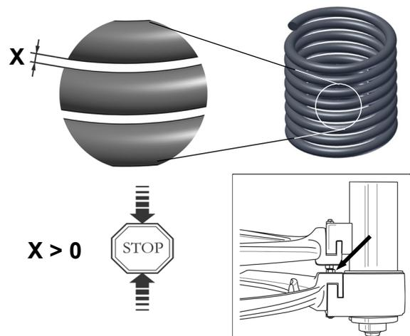
Abb. 12. Die Feder soweit spannen, bis keine Spannung mehr auf der Kolbenstangenmutter ist.
