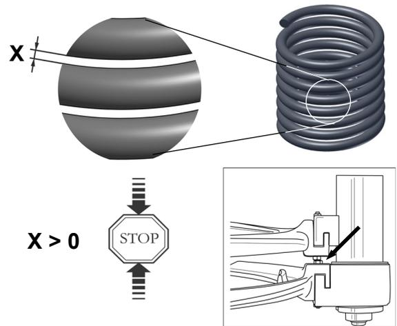
Zum Spannen der Feder, die Antriebsmutter wie in **Abb. 34** gezeigt mit einer 1/2"-Umschaltknarre in Verbindung mit einem Steckschlüsseinsatz SW 24 mm im Uhrzeigersinn drehen.
