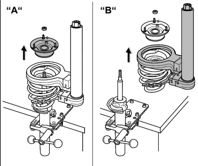
5. Federbeinstützlager und oberen Federteller abnehmen. **(Abb. 19 A)**
