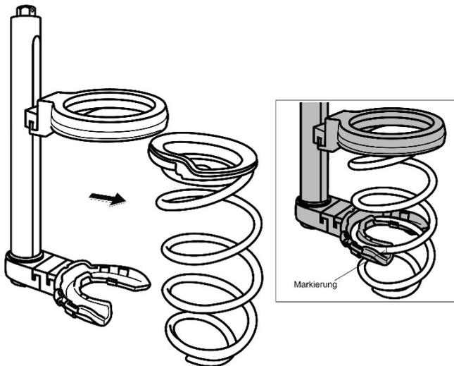
Abb. 33. Federspanngerät ist an der Feder angesetzt
