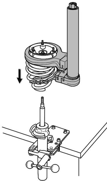
6. Den Spannvorgang stoppen, sobald das Federbeinstützlager auf die Kolbenstange aufgesetzt werden kann. **(Abb. 36)**
