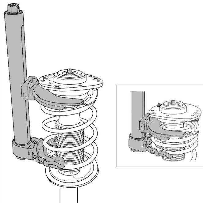
**(Methode 2): Feder ausbauen mit Spezial-Federhaltern, die auf den oberen Federteller greifen.**
