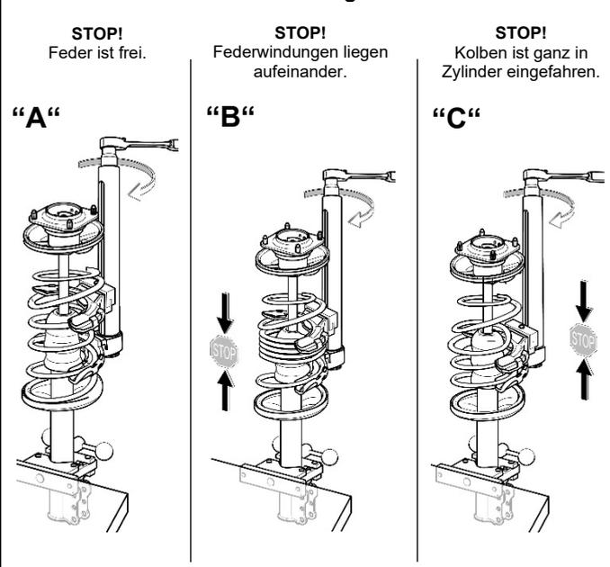
Zum Spannen der Feder, die Antriebsmutter wie in **Abb. 11** gezeigt, mit einer 1/2"-Umschaltknarre in Verbindung mit einem Steckschlüsseinsatz SW 24 mm im Uhrzeigersinn drehen und Feder soweit spannen, bis keine Spannung mehr auf der Kolbenstangenmutter ist. (**Abb. 12 A, B und C**)
