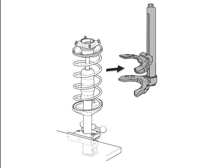
8. Federspanngerät aus der Feder herausnehmen. (Abb. 30)
