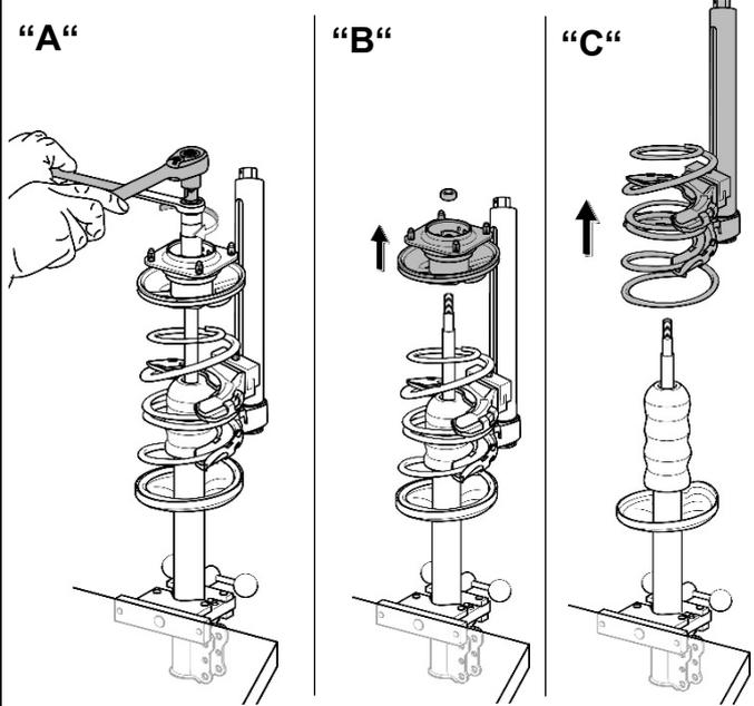
4. Kolbenstangenmutter lösen, z.B. mit dem Werkzeugsatz **KL-0056-100 K**. Federbeinstützlager und oberen Federteller abnehmen. (**Abb. 13 A und B**)
