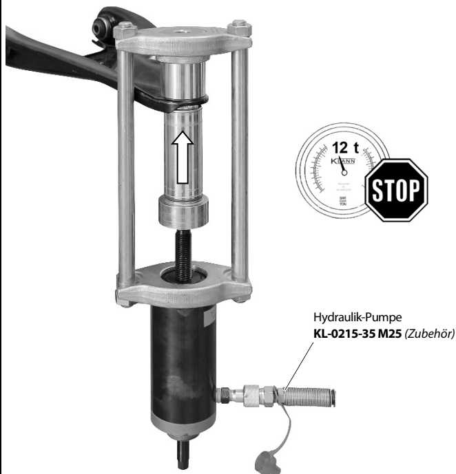
Abb. 7: Trag gelenk einbauen.
