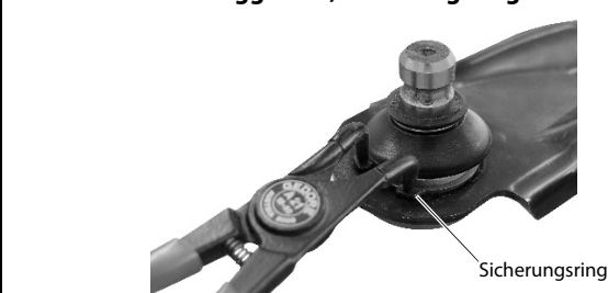
Abb. 20: Je nach Traggelenk, Sicherungsring montieren.
