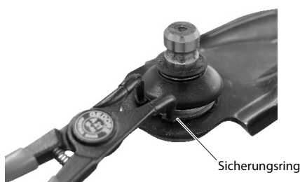
Abb. 8: Je nach Trag gelenk, Sicherungsring montieren.
