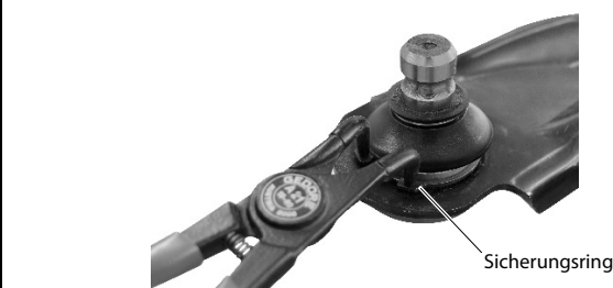
Abb. 13: Je nach Traggelenk, Sicherungsring montieren.
