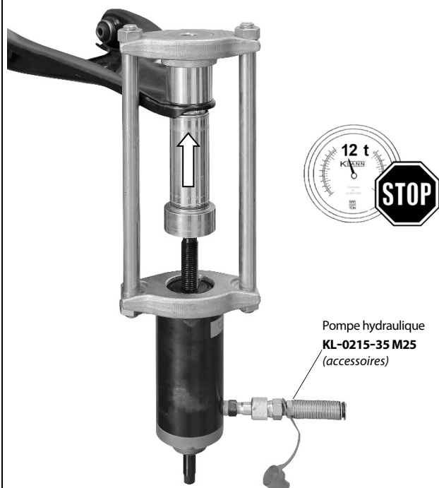
Fig. 8 : Selon la rotule de suspension, monter le circlip.
