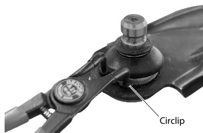
Fig. 8 : Selon la rotule de suspension, monter le circlip.
