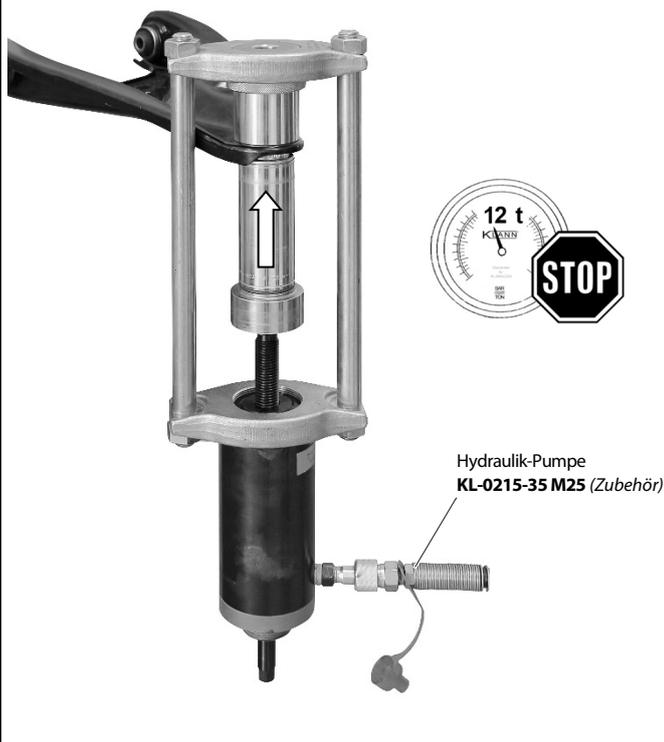
Abb. 8: Je nach Traggelenk, Sicherungsring montieren.
