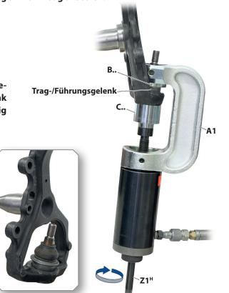
🗖 7: Trag-/Führungsgelenk lagerichtig nach Herstellervorgaben einpressen.
