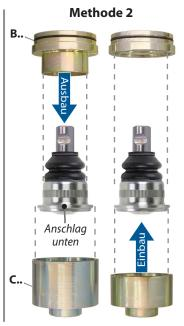
**1.** Je nach Durchmesser-Ø am Trag-/Führungsgelenk und erforderlicher Aus- und Einbau-Methode, passende Adapterringe [**B..**] und Druck-/Stützhülsen [**C..**] ermitteln.
