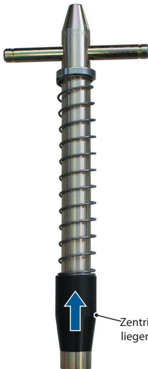
2. Zum wechseln des Reibkopfes [B..] ziehen Sie zunächst den **Zentrierkonus** am Grundwerkzeug [A] zurück und lösen nun die darunter liegende **Madenschraube** mit Hilfe eines **SW 2,5 mm** Innensechskant-Schlüssels.
