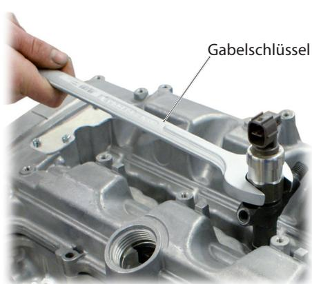
**📷4:** Schraubring am Injektor lösen und herausnehmen.
