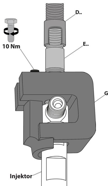
4. Je nach Aufnahmegewinde am Injektor einen passenden Zugadapter [E..] bzw. Düsenauszieher [G] anhand der Tabelle **❶**7 ermitteln.
