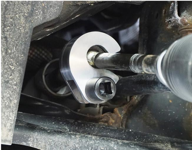
**📷 3:** Innere Spurstange lösen bzw. festziehen.
