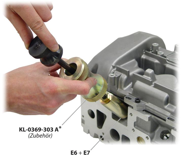
\* KL-0369-303 A bestehend aus: Schlagauszieher - KL-0049-100 A + Grundkörper - KL-0369-3031 B
