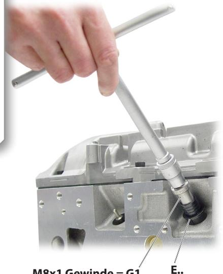
2. Den Gewindebohrer [G..] an einem T-Griff mit Steckschlüsseinsatz **SW10** oder ähnliches einsetzen.
