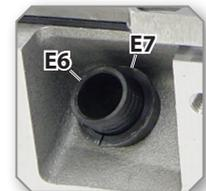
**📷3: Nur bei Führungshülse [E6] und Zentrierhülse [E7] diese zusätzlich festsetzen.**
