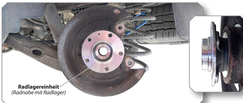
7. Prüfen Sie die korrekte Einbaulage der Radlagereinheit und bauen Sie das Fahrzeug nach Herstellervorgaben wieder zusammen.
