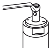
Fig. 20: Desserrer l'écrou de tige de piston.
