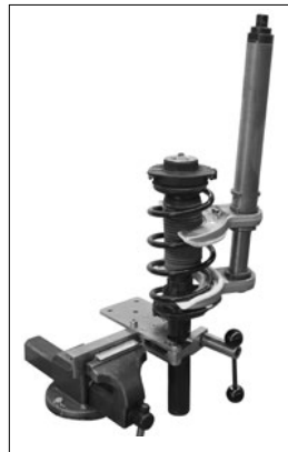
Fig. 8: Serrer la jambe de force/d'amortisseur dans le dispositif de fixation.
