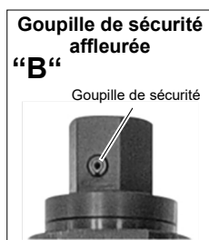
Fig. 42: Pose : goupille de sécurité de l'écrou d'entraînement.
