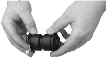
Abb. 8: Stützhülsen zusammenbauen.
