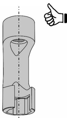
Antrieb und Abtrieb nicht auf gleicher Achse
