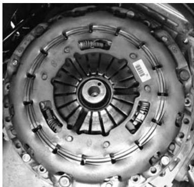
**Des. 3 :** Précontraindre et monter le mécanisme à l'aide du KL-0500-45 .
