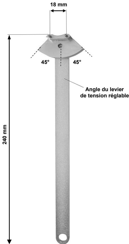
Tendre les courroies dentées à l'aide de KL-0284-91 A
