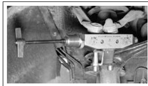
**Attention :** lors de l'extraction par pression de vis de pression hexagonales fortement rouillées, une arête importante peut se former sur la tige du boulon. Enlever l'arête, par ex. à l'aide d'une meuleuse d'angle. Pour cela, démonter l'outil, meuler l'arête, puis remonter l'outil comme indiqué aux points 3 à 5 et continuer l'extraction par pression.
