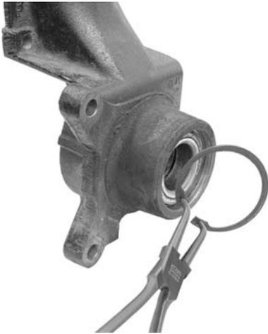
**KL-0192-5 - Pince pour circlips Ø40-100**
