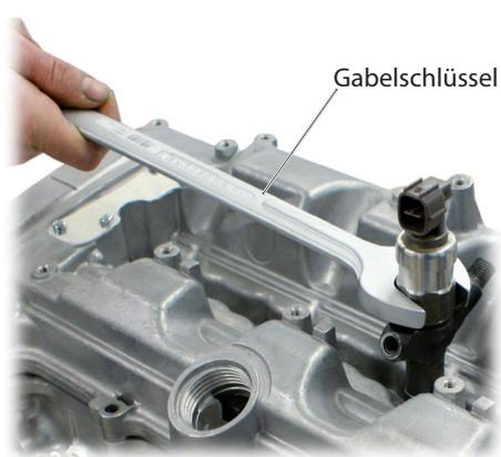
**📷4:** Schraubring am Injektor lösen und herausnehmen.
