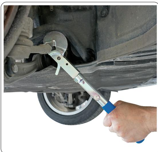
Durch Einlegen des Adapters in die Verstellzange ist diese auch passend für dünnere Spurstange mit einem Durchmesser-Ø von ca. 11 mm.
