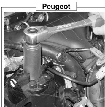
**KL-0122-56 - Clé à filtre à carburant, 27mm surpan**
