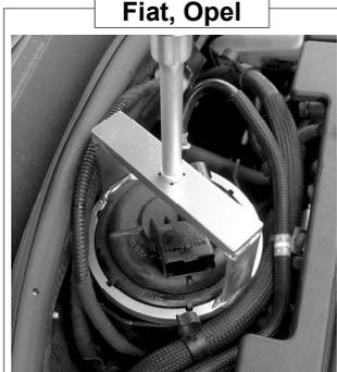
**KL-0122-610 - Clé à filtre à carburant, Ø 109 mm**
