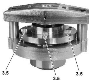
Fig. 25 : Insérer les goupilles de maintien dans la plaque de traction/pression.
