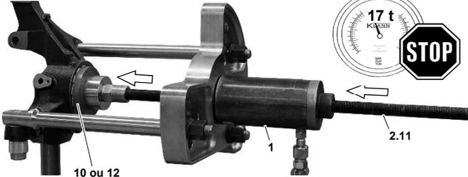
Fig. 46 : La bague de sécurité est complètement enclenchée dans la rainure.
