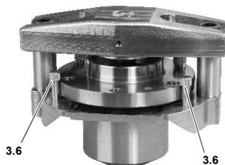
Fig. 26 : Vérin hydraulique avec tige filetée de traction/pression et écrou de serrage.
