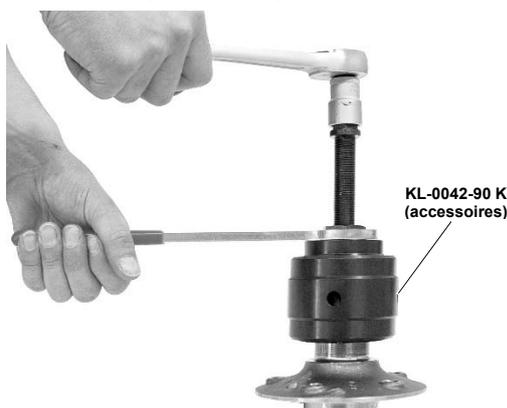
7. Visser l'adaptateur "2.10" sur le vérin hydraulique "1" (côté traction).
